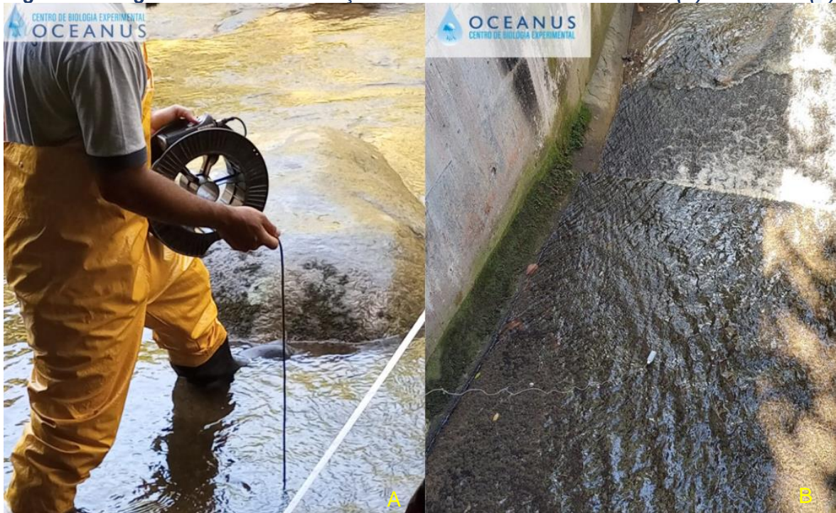
Figura 2-4 – Figura ilustrativa da medição de vazão com o uso de molinete (A) e flutuador (B).
