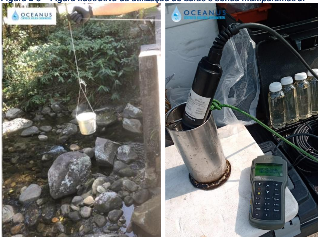
Figura 2-3 – Figura ilustrativa da utilização do balde e sonda multiparâmetro.
